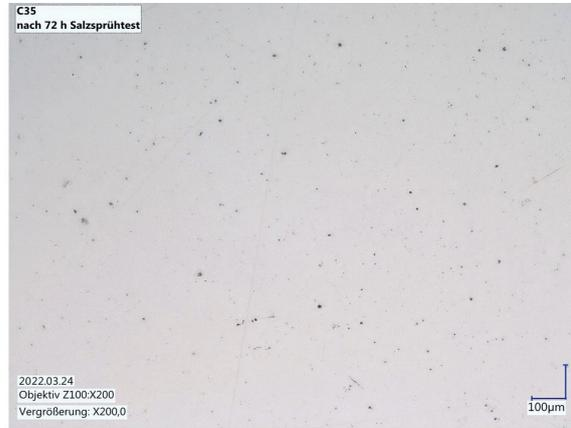
Vergleich zwischen einer typischen CrN-Schicht und einer C35 nach einem 72 Stunden Salzsprühstest. (Gemäss ISO 9227)
