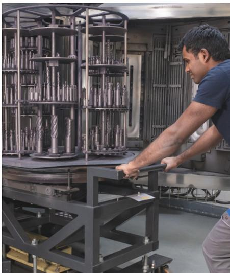
Mit unserer HDP PVD Arc Technologie entwickeln und gestalten wir für Sie angepasste Beschichtungslösungen für die umfangreichen Anforderungen im Medizinal Sektor. Wir haben uns auf die Beschichtungen von heiklen Substraten wie z.B. Titan, komplexe Polymere sowie medizinische Implantate spezialisiert, welche bei niedrigen Temperaturen beschichtet werden. So konnten wir über die Jahre starke Partnerschaften in der Medizinal Industrie aufbauen.
