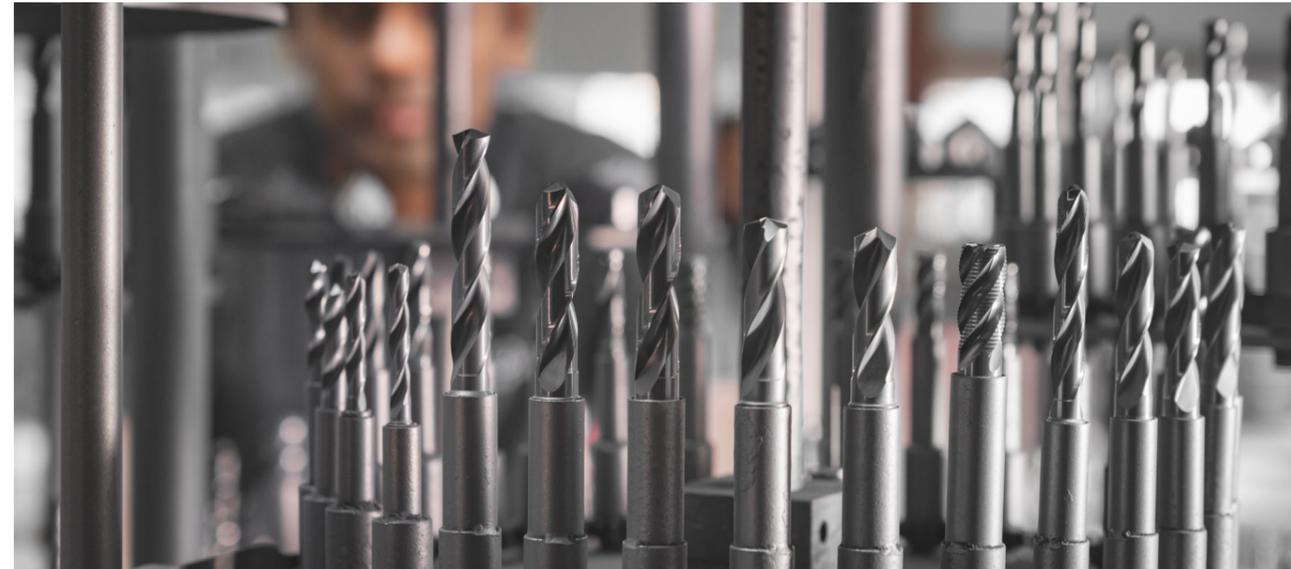
Die neue HDP (High-Density Plasma) Lichtbogentechnologie von Swiss-PVD Coating AG erlaubt die Erzeugung höherer Plasmadichten. Dies führt zu einer deutlichen Steigerung der Beschichtungsdichte, sowie zu höherer Härte und Zähigkeit der Schichten. Zusätzlich wird die Gleichmäßigkeit des Schichtauftrags verbessert, was einen positiven Einfluss auf die Produktivität zur Folge hat.
