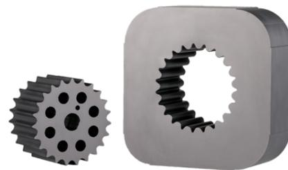
HDP AliNOX a été développée tout spécifiquement pour les applications sur l'acier inox, les alliages CoCr, CuBe et Aluminium et le titane. Notre revêtement est optimisée pour limiter l'adhérence de la matière travaillée et du revêtement. Avec sa dureté modérée, sa forte résistance à la rupture et sa densité importante, la couche AliNOX démontre d'excellents résultats dans le fraisage à sec et avec lubrification minimale d'acier de dureté 50-64 HRC.
